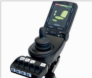
Joystick CJS2 et Keypad (option) pour faciliter la conduite et sécuri- ser l'usage des différentes positions.
