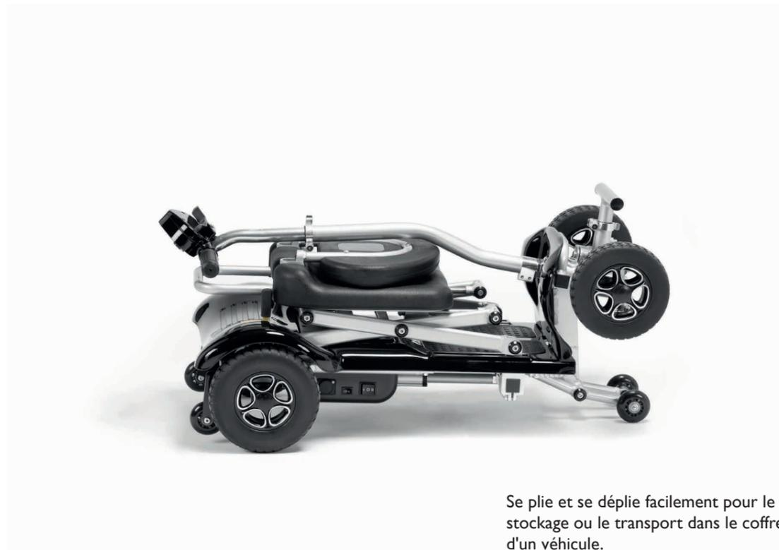
Se plie et se déplie facilement pour le stockage ou le transport dans le coffre d'un véhicule.
