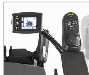
Contrôle optimal : écran LCD et joystick sur pantographe.
