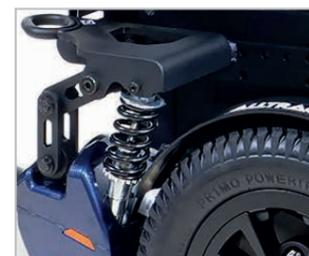
Suspension interactive des 6 roues et du siège pour plus de stabilité, de mobilité et de confort.
