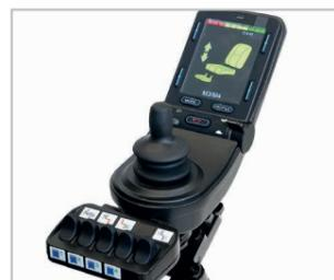
Joystick CJS2M et Keypad (option) pour faciliter la conduite et sécuriser l'usage des différentes positions.
