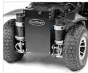
Avec ses deux batteries de grande capacité, l'Outchair peut parcourir jusqu'à 35 km sur terrain plat.
