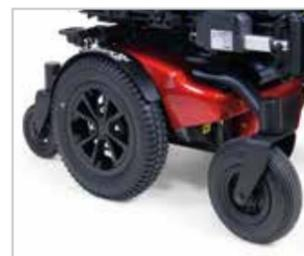
Configuration hybride qui combine les caractéristiques des traction médiane et propulsion arrière.
