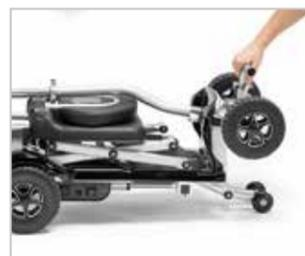
Transportable grâce à une poignée et des roulettes.
