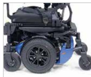
Configuration à traction médiane et suspension interactive des 6 roues et du siège pour plus de stabilité, de mobilité et de confort.
