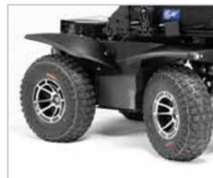
Equippé de 4 roues motrices avec une puissance de 350W sur chaque moteur. Il peut atteindre 10 km / h.
