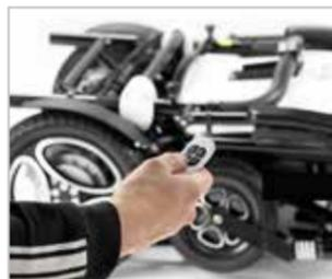
Grâce à sa télécommande, il se plie et se déplie en 5 secondes.
