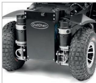
Avec ses deux batteries de grande capacité, l'OutChair peut parcourir jusqu'à 35 km sur terrain plat.
