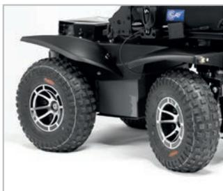
Équipé de 4 roues motrices avec une puissance de 350W sur chaque moteur. Il peut atteindre 10 km / h.
