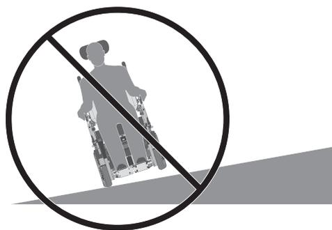
**Figure 2.** Ne pas tourner dans une pente.
