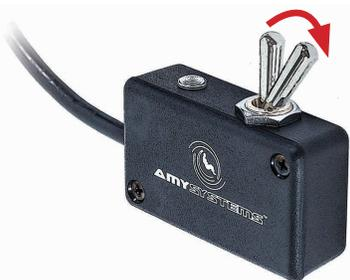
Pour activer l'option motorisée du siège, faire incliner l'interrupteur vers l'arrière et le maintenir ainsi jusqu'à ce que la position désirée soit atteinte, puis relâcher. Pour revenir à la position neutre, incliner vers l'avant et maintenir l'inclinaison.
