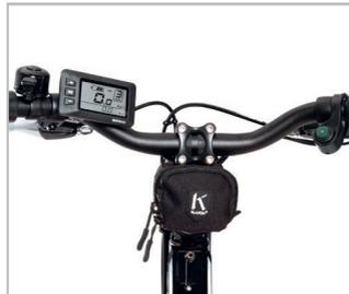
Guidon pliable et réglable, écran LCD multifonction, 5 vitesses et régulateur de vitesse.
