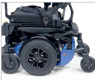
Configuration à traction médiane et suspension interactive des 6 roues et du siège pour plus de stabilité, de 10 mobilité et de confort.
