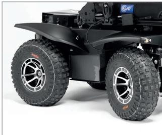
Équipé de 4 roues motrices avec une puissance de 350W sur chaque moteur. Il peut atteindre 10 km / h.
