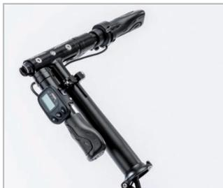
Guidon pliable et réglable, écran LCD multifonction et 5 vitesses.
