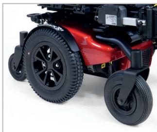
Configuration hybride qui combine les caractéristiques des traction médiane et propulsion arrière.
